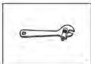
Clé à molette de 10 po (254,0) avec ouverture jusqu'à 1 1/8 po (29,0 mm)
